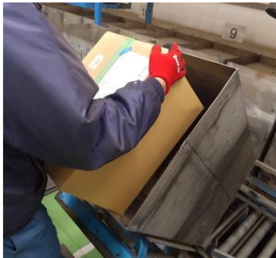
照射容器への充填作業
