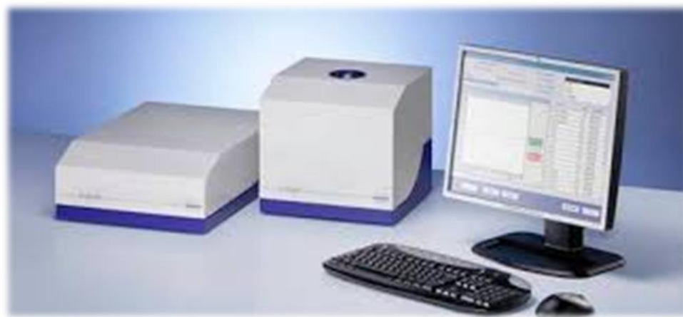
電子スピン共鳴装置にて線量測定
