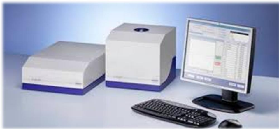
電子スピン共鳴装置にて線量測定
