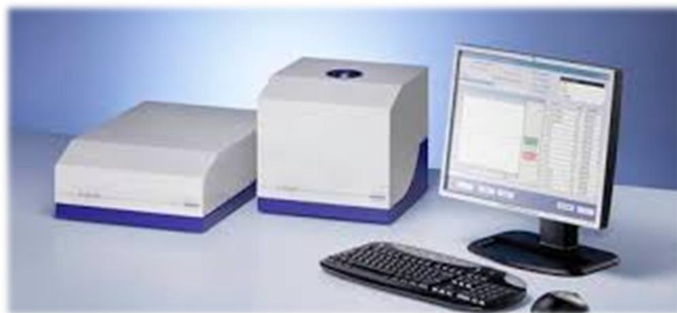
電子スピン共鳴装置にて線量測定
