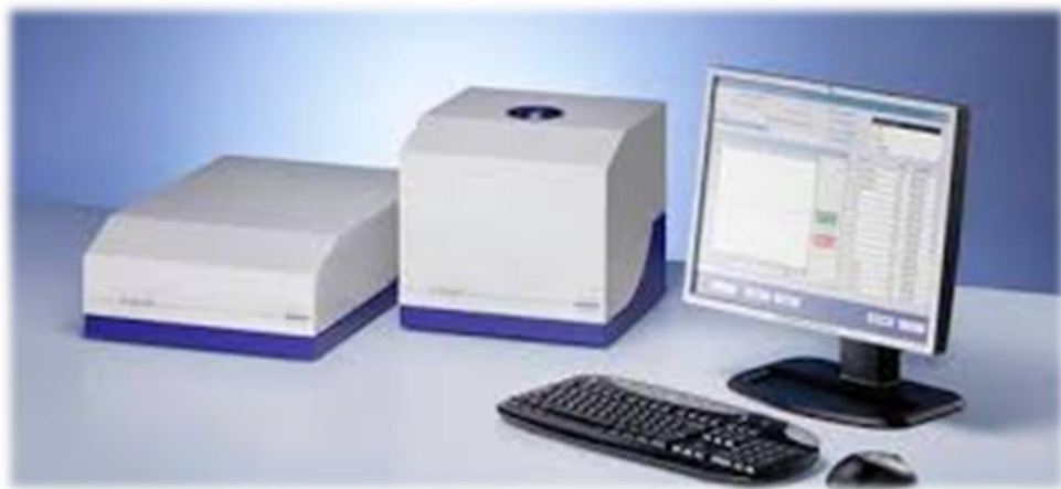
電子スピン共鳴装置にて線量測定
